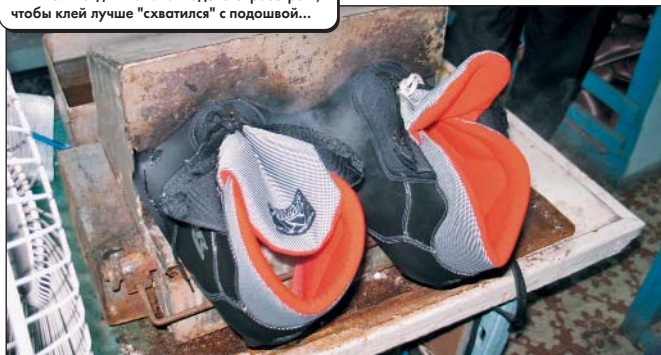
Эта чудо-машина одновременно склеивает и прибивает маленькими гвоздиками "каркас" к первому слою подошвы. Теперь остаётся только приклеить саму подошву, и ботинок готов к использованию.
