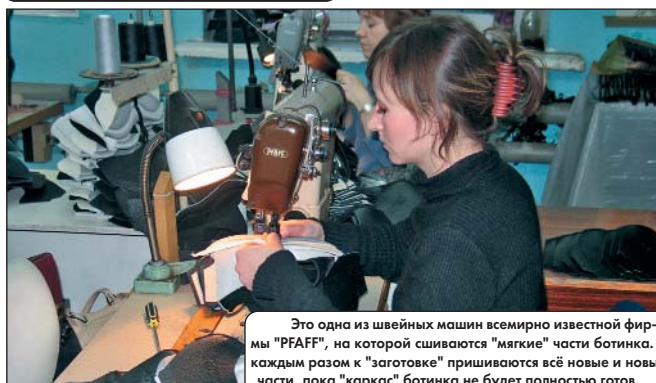
Лыжный ботинок состоит из множества материалов. Сначала все они поступают на склад, а затем — в раскройный цех, где из них вырезают отдельные детали ботинка, которые впоследствии будут сшиваться в заготовочном цехе.
