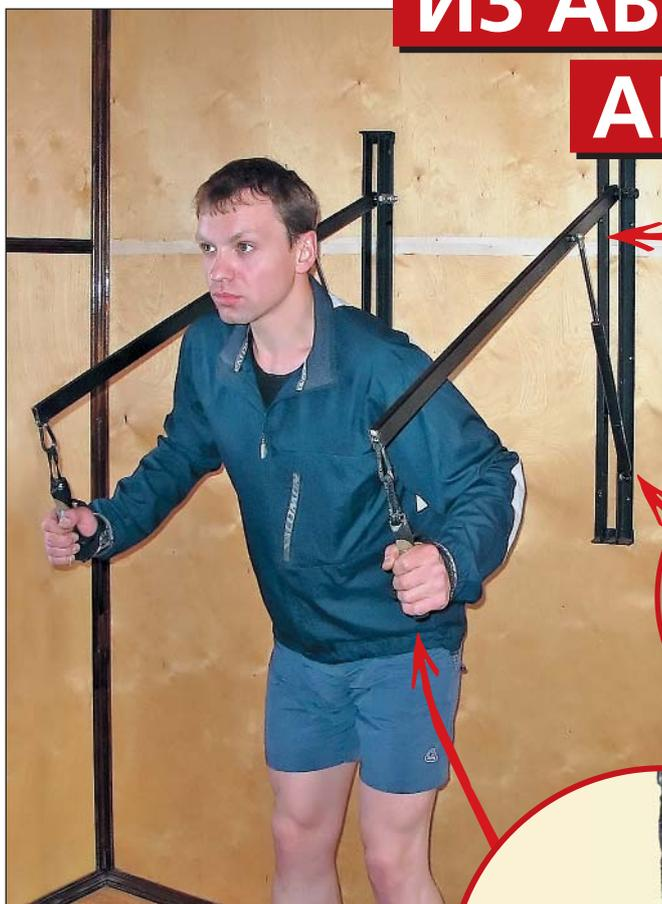
Автор изобретения Владлен Ершов во время тренировки на своём тренажёре. Конструкция на первый взгляд выглядит довольно простой: две металлические балки, между ними амортизатор, а на конце рычага — лыжная ручка с темляком. Почему бы и вам не попробовать?
